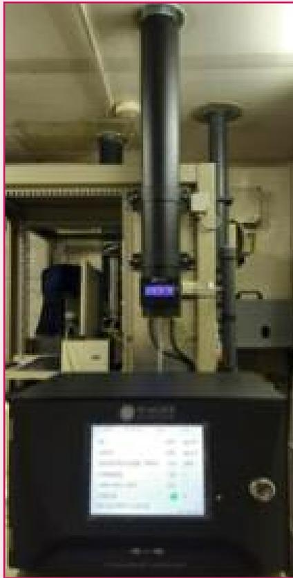
Figura 2. Etalometro AE33 installato presso la centralina
