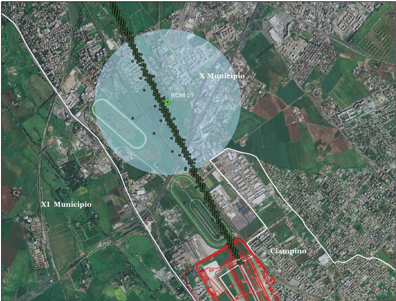
Fig. 17 - Esempio di metodologia di correlazione tra le battute radar e la posizione della stazione di misura
