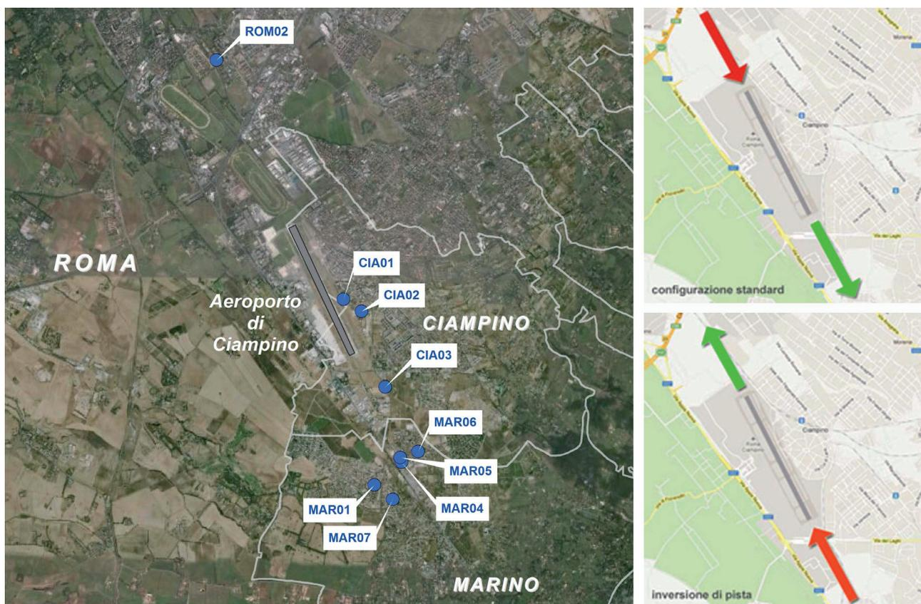
Fig.14 - Posizionamento delle stazioni di misura a Ciampino sotto i profili di atterraggio e decollo
