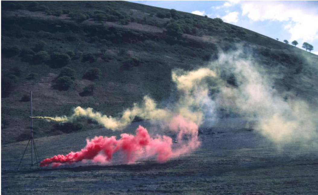
Fig. 22.1: fotografia istantanea di due rilasci di gas colorati emessi da due sorgenti puntuali molto vicine tra loro (Thomson et al. 2011).
