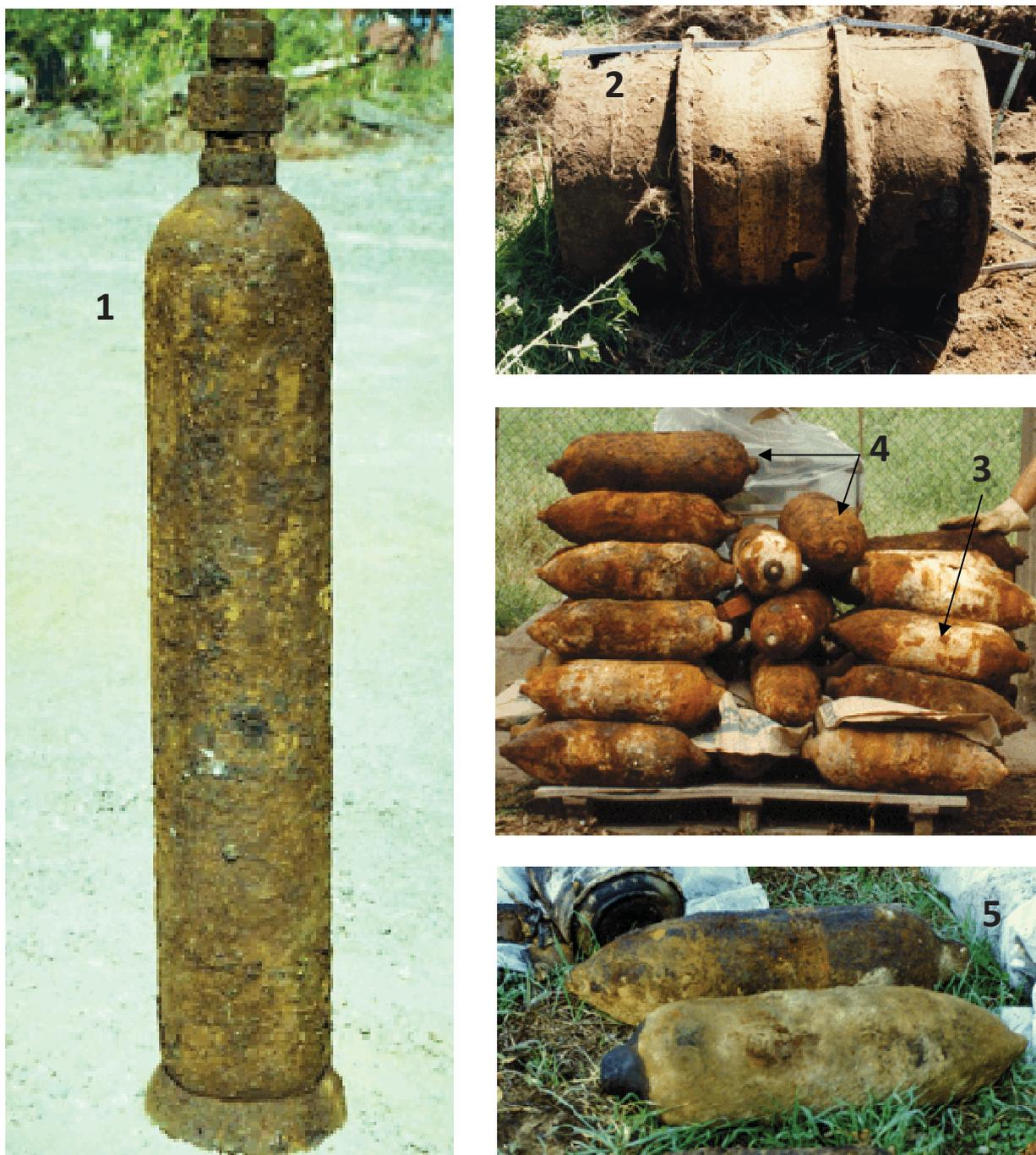
**Figura 24 – Materiali rinvenuti nel corso della bonifica del 1995-96: 1 ) Bombola di piccola capacità (120 x 1000 mm, 6 l) caricata a fosgene liquefatto; 2) fusto metallico tipo “C” per trasporto di aggressivi chimici con le caratteristiche bande colorate indicative dell’iprite; 3) bombe d’aereo italiane C25P all’iprite; 4) proietti “Livens” inertizzati; 5) bombe d’aereo italiane C25P caricate con iprite (si noti la fuoriuscita dell’aggressivo dalla coda)**
