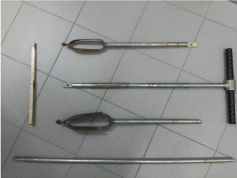
**Figure 12 - Trivella manuale Edelman usata per la realizzazione dei fori nei test di infiltrazione**
