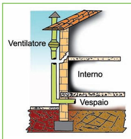
delle bocchette di aerazione già presenti porta a un abbassamento della concentrazione di radon.
