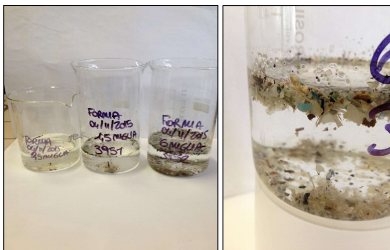
Figura 13 – contenuto retino post campionamento, frazione flottante/precipitato
