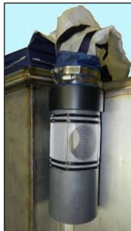
Figura 12 – Retino Manta e collettore di raccolta per le microplastiche
