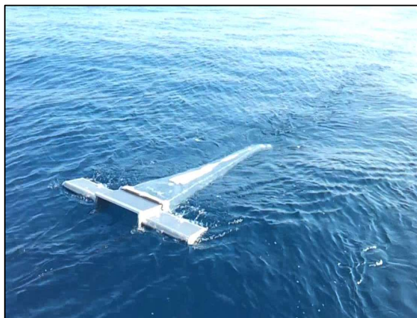
Figura 12 – Retino Manta e collettore di raccolta per le microplastiche
