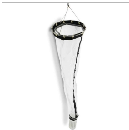
Figura 7- Retino WP2 per il campionamento dello Zooplancton-
