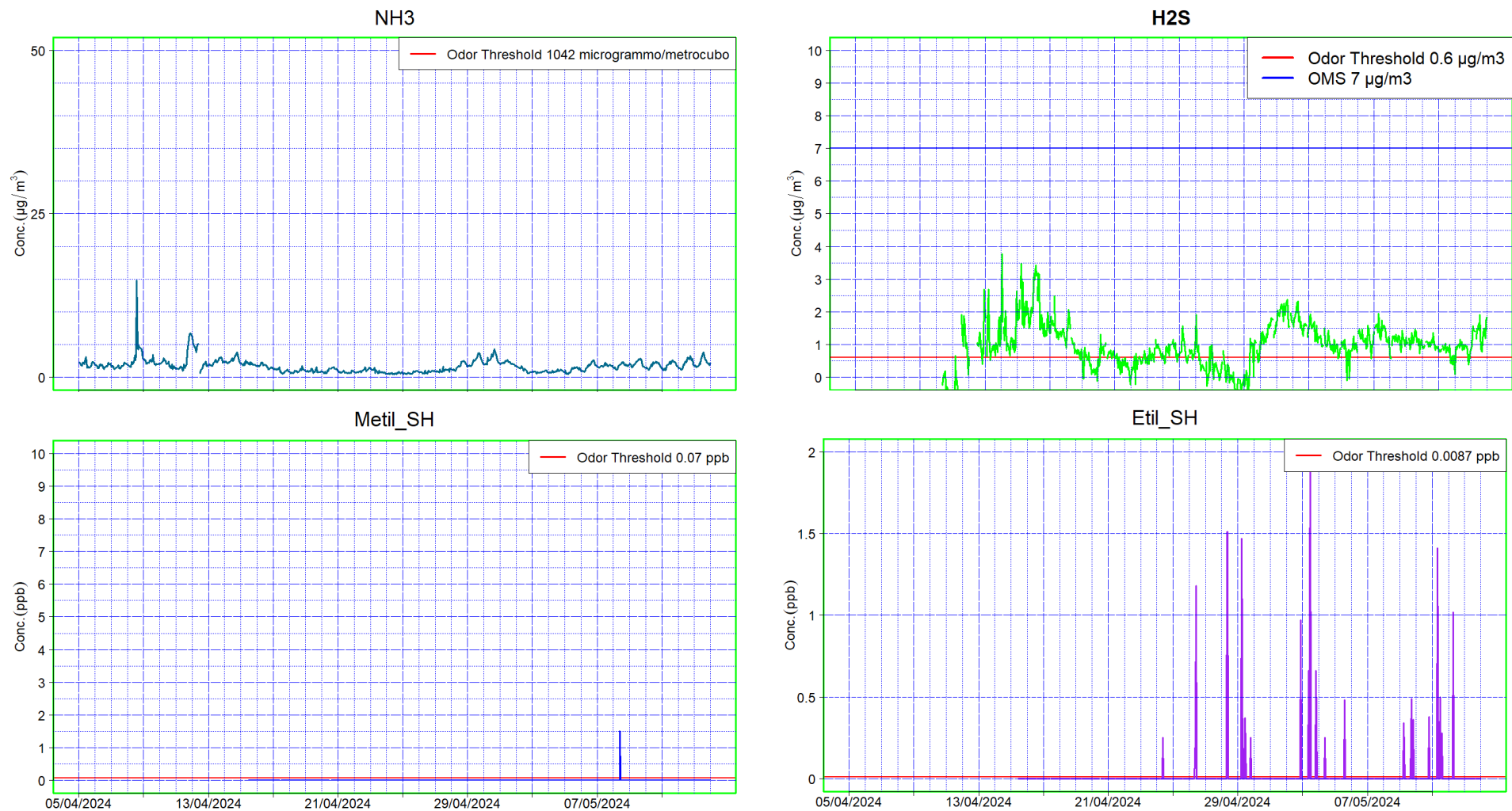
Figura 2: grafici della campagna di misura presso Rieti per ammoniaca, acido solfidrico, metil-mercaptano ed etil-mercaptano
