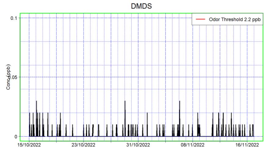
Figura 4: grafici della campagna di misura presso Gallese per 2-butil mercaptano, dimetil-solfuro, metil-etil-solfuro, dimetil-disolfuro;
