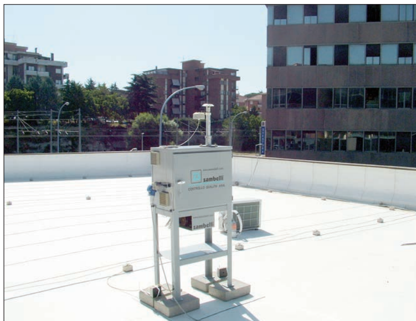
Fig. 1 - Stazione di campionamento aria Viterbo
