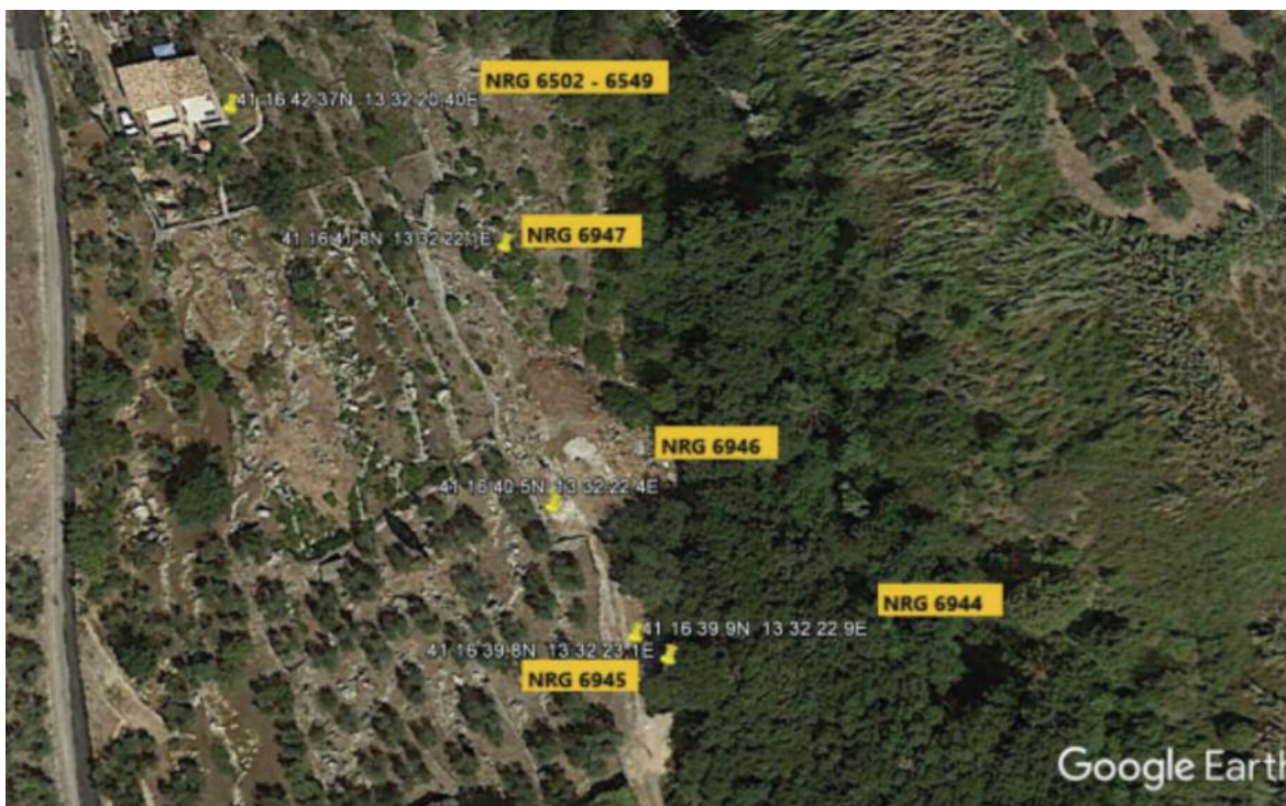
Figura 39: Mappa con indicazione della localizzazione del campionatore ad alto volume e dei 4 campionatori passivi.
