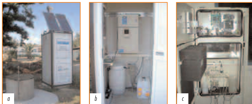
Fig. 8.7 – Esterno (a), interno (b) e circuito (c) di una stazione di monitoraggio in continuo .
