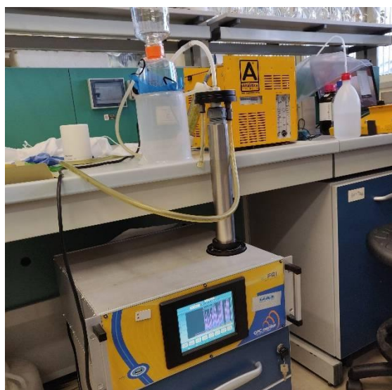
Fase 4: Misura nella camera di aspirazione
