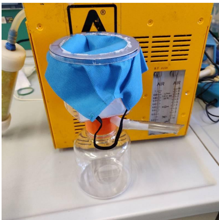
Figura 1 - Portamascherina e camera di misura in depressione
