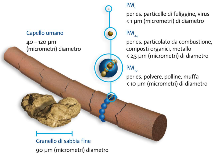
Figura 1 - Le dimensioni del particolato atmosferico da 10 a 1 µm di diametro (Freudenberg Filtration Technologies).
