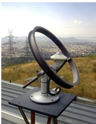
Fig. 11.96: piranometro con shadow-ring per la misura della radiazione solare diffusa
