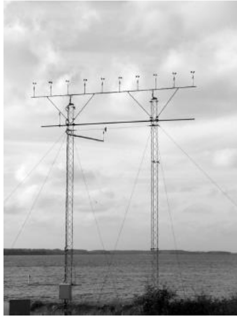
Fig. 11.50: calibrazione in campo degli anemometri (Kristensen e al, 2001)
