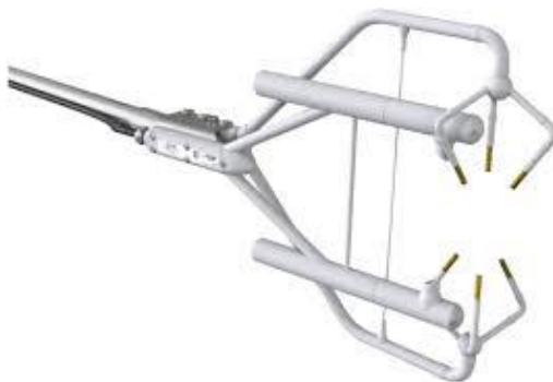
Fig. 13.35: il sensore IRGASON costituito da un IRGA open-path integrato in un anemometro ultrasonico triassiale CSAT-3 (Campbell Scientific)
