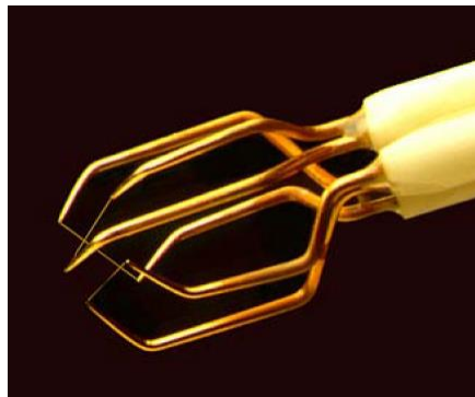
Fig. 11.43: configurazione triassiale dell'anemometro a filo caldo
