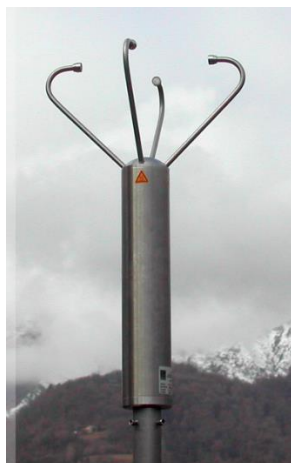
Fig. 11.29: anemometro ultrasonico biassiale (Metek GmbH)
