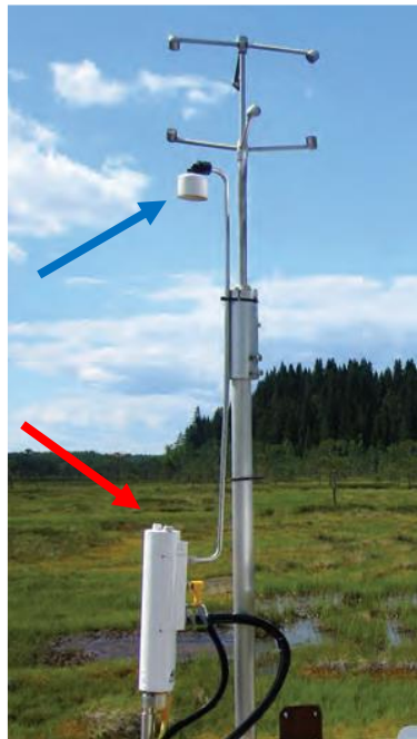
Fig. 13.38: il sensore LI-7200 Enclosed della LI-COR (con una freccia rossa è stata indicata la cella di misura mentre con una freccia blu il punto di prelievo dell'aria)
