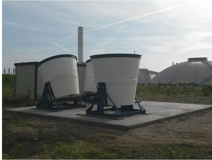
Fig. 11.128: SODAR Doppler triassiale operato dal CNR-ISAC presso la centrale di Torrevaldaliga Nord (Civitavecchia)
