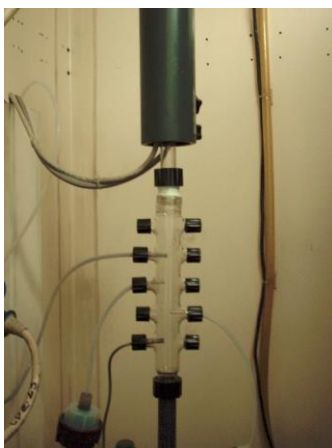
Fig. 11.80: linea di prelievo in vetro pyrex (manifold)
