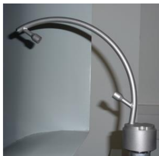
Fig. 11.28: moderna realizzazione di un anemometro ultrasonico mono-assiale (uSonic-1 Flow, Metek GmbH)
