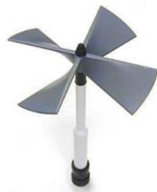
Fig. 11.17: tipico propeller di forma elicoidale (R.M. YOUNG Company)
