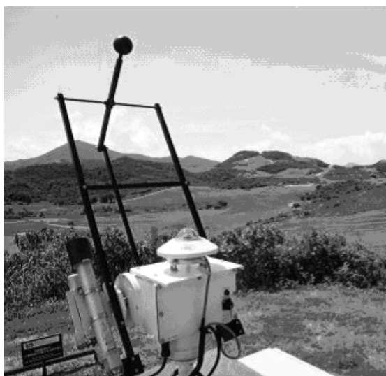
Fig. 11.97: piranometro con shadow-disk per la misura della radiazione solare diffusa
