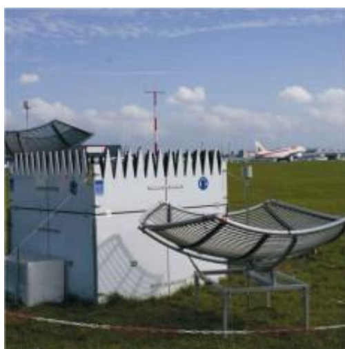
Fig. 11.133: due soluzioni tecniche SODAR-RASS. La soluzione di sinistra utilizza SODAR array, mentre in quella di destra viene impiegato un SODAR Doppler triassiale in configurazione monostatica (Metek GmbH)
