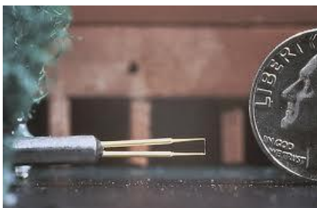
Fig. 11.37: confronto tra le dimensioni di una moneta e quelle dell'elemento sensibile di un anemometro a filo caldo
