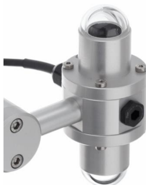
Fig. 11.103: esempio di radiometro netto dove sono visibili i due pirradiometri che lo compongono (Hukseflux)
