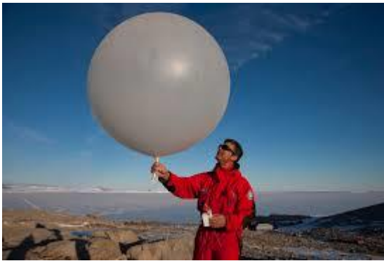
Fig. 11.119: radiosonda poco prima del lancio in atmosfera (a sinistra); a destra il payload tipico di una radiosonda. Le dimensioni del sistema in figura sono 22cm x 8 cm x 7.5 cm.
