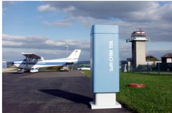
Fig. 11.135: il moderno ceilometer CHM 15k "NIMBUS" (LUFFT)
