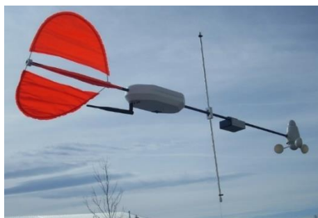
Fig. 11.122: particolare del sistema di misura della velocità e della direzione del vento
