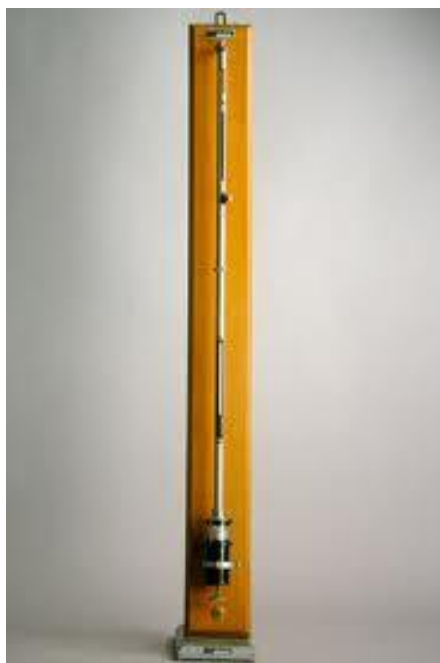
Fig. 11.111: antico esemplare di barometro a mercurio
