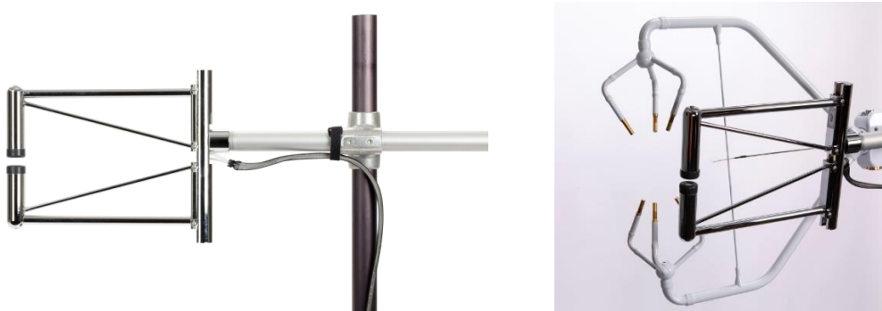
Fig 11.76: a sinistra un igrometro veloce open-path con lampada al Cripto (Campbell – KH20) e a destra lo stesso igrometro accoppiato ad un anemometro ultrasonico triassiale (Campbell CSAT3)
