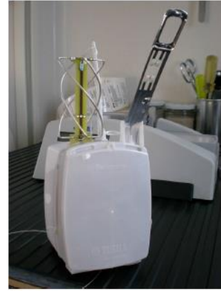
Fig. 11.119: radiosonda poco prima del lancio in atmosfera (a sinistra); a destra il payload tipico di una radiosonda. Le dimensioni del sistema in figura sono 22cm x 8 cm x 7.5 cm.
