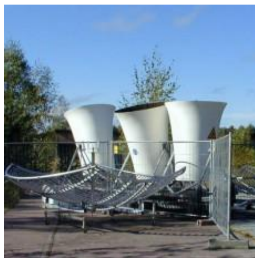
Fig. 11.133: due soluzioni tecniche SODAR-RASS. La soluzione di sinistra utilizza SODAR array, mentre in quella di destra viene impiegato un SODAR Doppler triassiale in configurazione monostatica (Metek GmbH)
