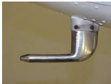
Fig. 11.47: Tubo di Pitot sotto la fusoliera di un aeromobile
