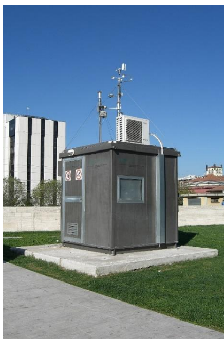
Fig. 11.78: tipica Centralina di monitoraggio della qualità dell'aria (ARPA Umbria, stazione di Perugia)
