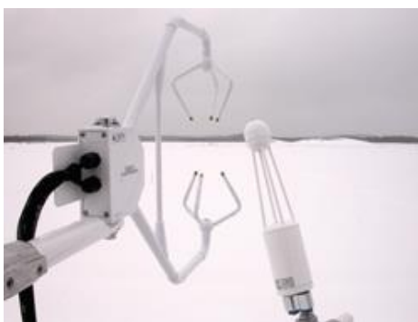
Fig. 11.35: Anemometro ultrasonico triassiale accoppiato con un misuratore veloce all'infrarosso di H_2O e CO_2 (LI-COR Biosciences)
