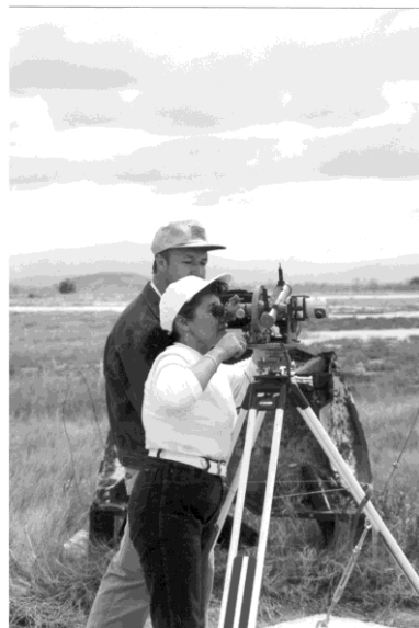
Fig. 11.117: inseguimento di un pallone pilot con un teodolite (Sozzi - Mexico City).
