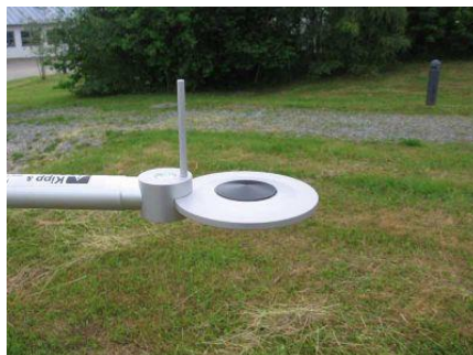
Fig. 11.105: radiometro netto di nuova costruzione senza cupole (Kip&Zonen)
