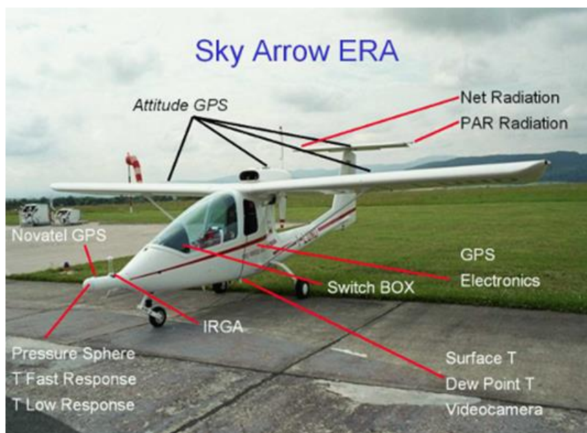
Fig. 11.124: l'aereo strumentato SKY Arrow ERA per l'esplorazione del PBL (CNR-ISAFOM)
