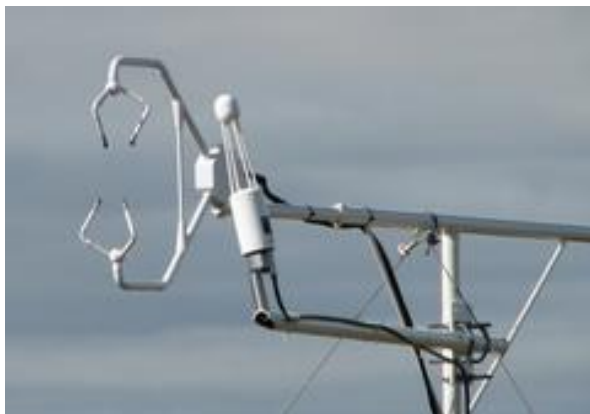
Fig.13.6: tipica stazione Eddy-Covariance costituita da un anemometro ultrasonico triassiale e da un misuratore all'infrarosso (IRGA) di H_2O e CO_2 (da www.awi.de )
