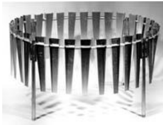
Fig. 11.115: schermo protettivo antivento per il pluviometro
