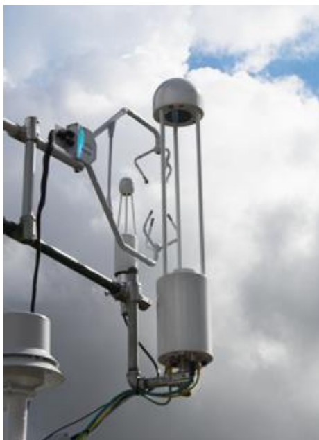
Fig. 11.89: stazione EC. Il sensore al centro in alto a sinistra dell'anemometro ultrasonico è l'analizzatore per il metano open path LI-COR 7700. Sullo sfondo il sensore open-path LI-COR 7500 per H 2 O/CO 2
