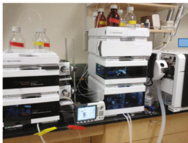
L'analisi strumentale con cui vengono analizzate le microcistine è eseguita in HPLC/SPE-on line e MS.
