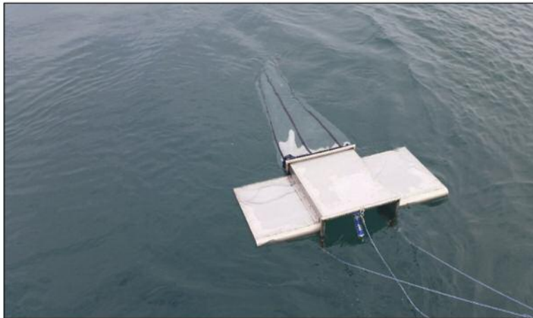
Figura 20 - Retino Manta, usato per effettuare i campionamenti delle microplastiche nell'ambito del descrittore 10 di Strategia Marina
